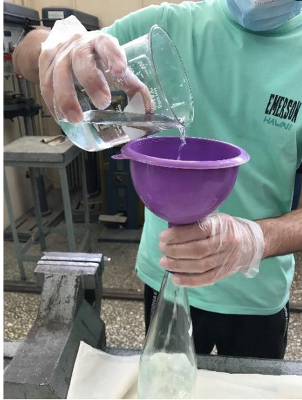
12. Ακριβής ογκομέτρηση μεθανόλης
