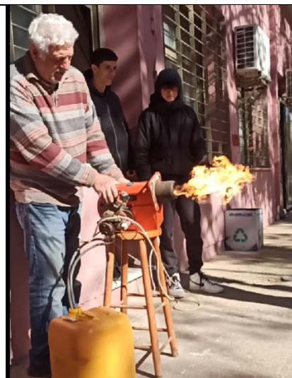
22. Δοκιμή καύσης σε καυστήρα
